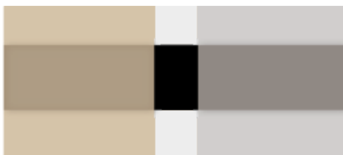
Figura 1. Imagem de lâminas de AllCem nas cores A3 (esquerda) e Trans (direita). A espessura das lâminas é de 500 \mu\text{m} .
